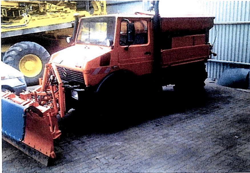
Das Streufahrzeug mit Schiebschild für das Servicepaket Winterdienst
